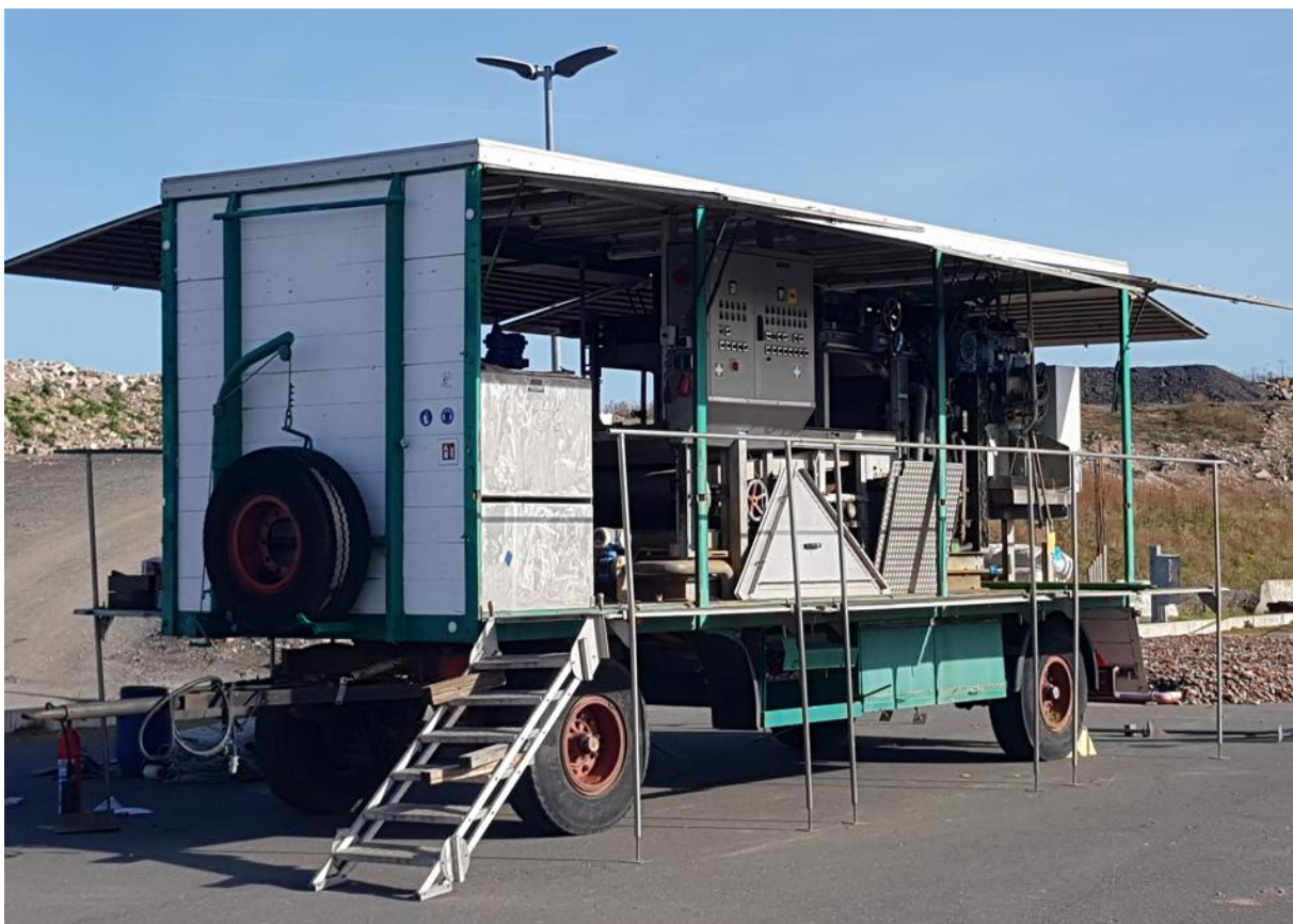
Bild 2: Siebbandfilterpresse im ausgeklappten Zustand (Foto 2023)
